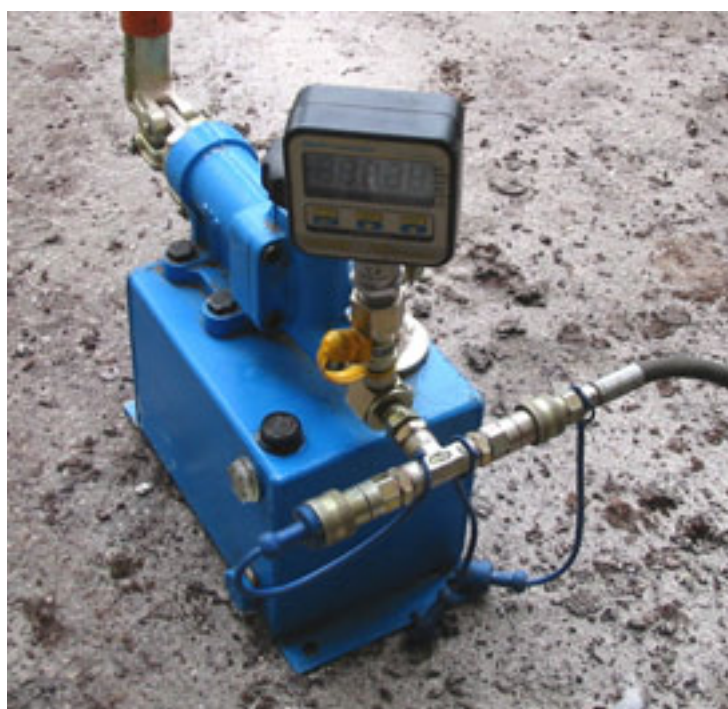
Foto 4. manometro digitale collegato alla pompa idraulica
